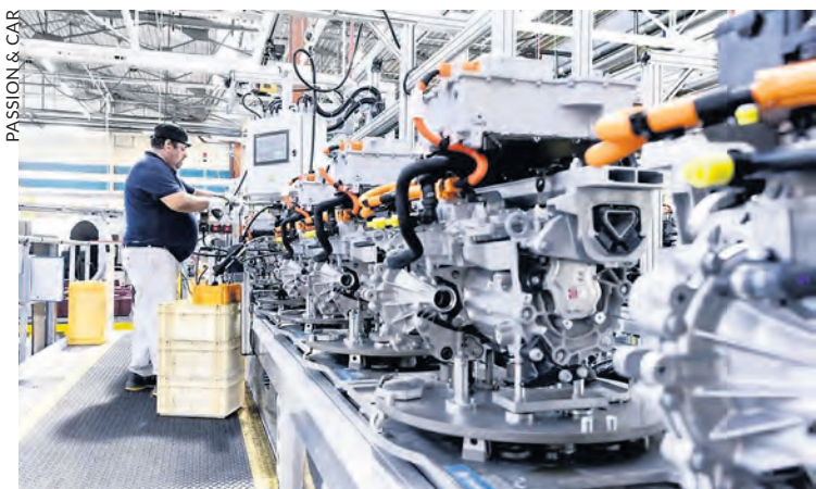
La chaîne montage moteur diesel à Trémery.
